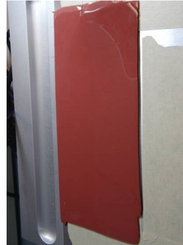
Pour second layer of silicone
